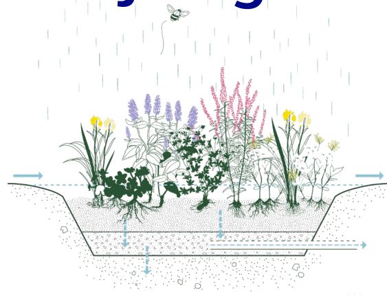
Regnbed - et forsenket blomsterbed i terrenget som samler regn- og overvann
